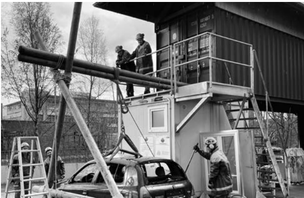
Hilfskonstruktion zum Heben von Lasten und Interaktives Lernen der Betreuer
