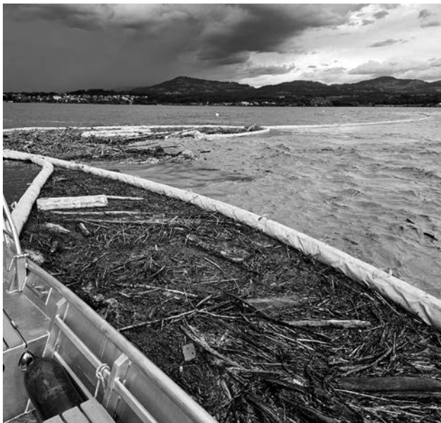
Einsatz der Schwemmholzperre
