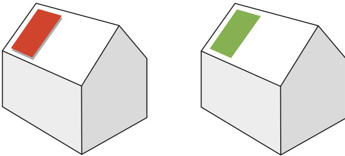
Einer der wichtigsten Grundsätze für den Einbau von Solaranlagen ist eine flächige Integration in die Gebäudehülle. Aufgesetzte Anlagen bilden optisch keine Verbindung zur Dachebene und sind bei Neubauten oder Generalsanierungen zu vermeiden. Ist ein ebener Einbau nicht möglich, sollte eine möglichst geringe Aufbauhöhe gewählt werden.
