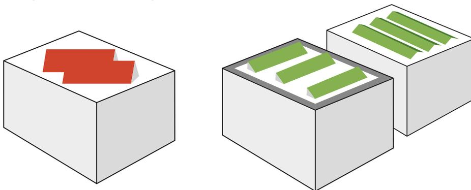
Aufgeständerte Anlagen sind generell nur auf Flachdächern zu empfehlen. Die Anlage soll innerhalb einer definierten Abstandslinie aufgestellt und parallel zum Dachrand installiert werden. Anlagen mit einer Neigung ab  $10^\circ$  zur Dachfläche sollten aus Arbeitssicherheitsgründen mindestens 50 cm vom Dachrand zurückgesetzt montiert werden. Anlagen unter  $10^\circ$  Neigung, beispielsweise für eine Ost/West Ausrichtung, können diesen Abstand unterschreiten.
