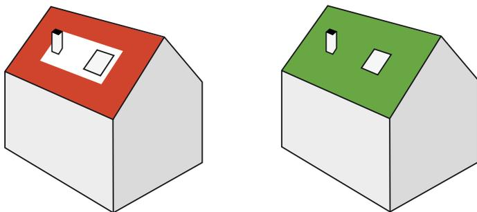
Aussparungen um Dachfenster oder Kamine stören das Erscheinungsbild. Eine vollflächige Integration der Anlage ist zu prüfen. Für die Flächen rund um Kamine, Dachfenster oder weitere Aufbauten eignen sich massgefertigte Abdeckungen, wie beispielsweise Blindmodule oder Bleche.
