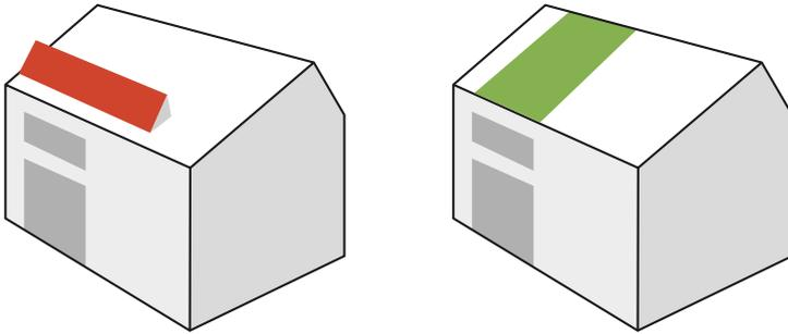
Solaranlagen nehmen die Orientierung und Neigung von Dachkanten und Dachflächen auf. Die Positionierung der Anlage leitet sich aus der bestehenden architektonischen Linienführung ab. Generell ist von konstruktiven Massnahmen wie z.B. Aufständungen und Ausdrehungen Richtung Süden abzuraten, um mehr Solarertrag zu erzielen. Aufständungen und Ausdrehungen bringen meist nur wenige Prozente mehr an Solarertrag, beeinträchtigen jedoch bestehende Strukturen massiv.
